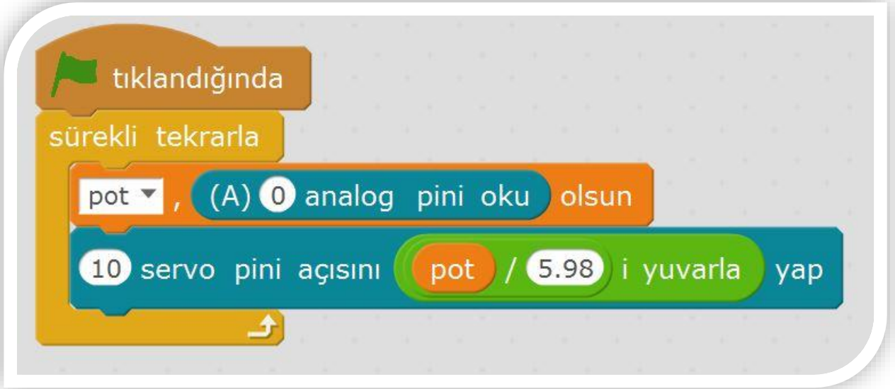
mBlock Kodu 14: Potansiyometre ile Servo Motor Döndürme Uygulaması
