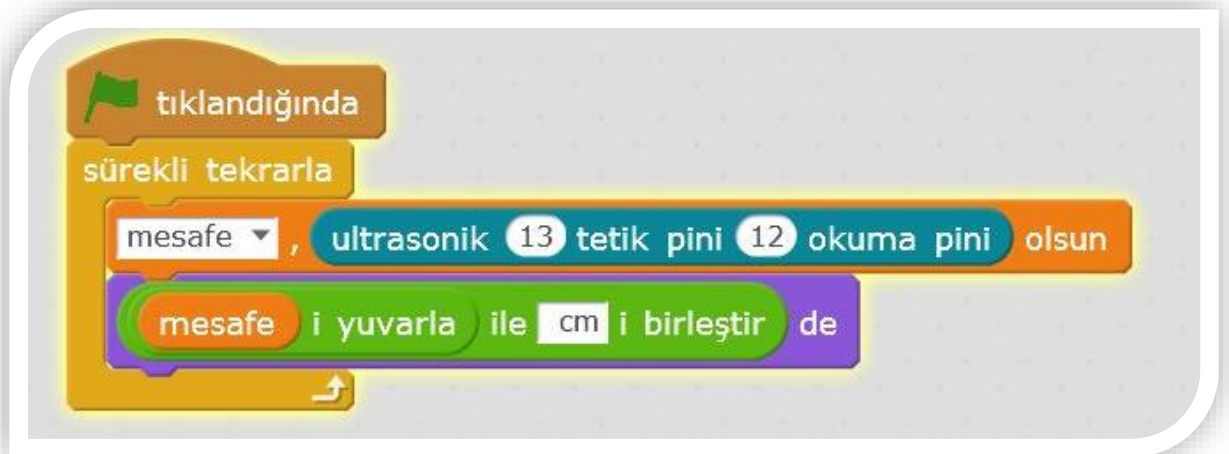
mBlock Kodu 8: HC-SR04 Mesafe Sensörü ile Uzaklık Ölçümü Uygulaması
