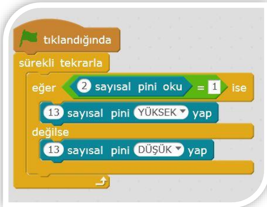
mBlock Kodu 5: Buton ile Buzzer Ses Üretici Uygulaması
